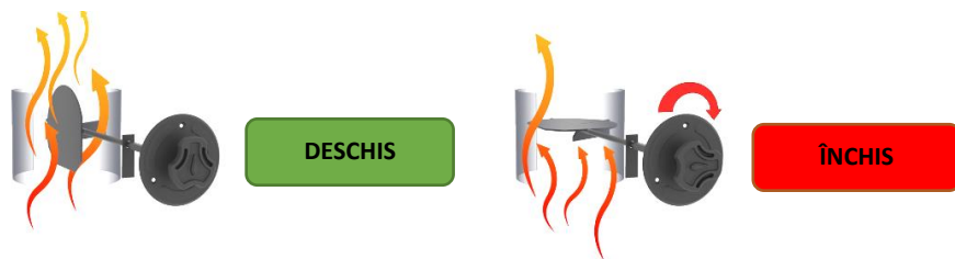
Schema 3 – Reglarea clapetei de evacuare a fumului
