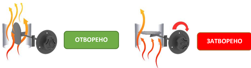
Схема 3 - Управление на клапата на дымоотвода
